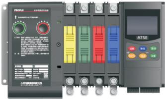
RDQ5S型自动转换开关电器（以下简称开关），是一种紧急时仍继续供电开关，开关由负荷开关（开关不含熔断丝或电流脱扣的ATSE）和智能控制器组成它以最新的微机控制系统为核心，电磁兼容性设计，抗干扰性强，长期连续工作稳定可靠，配以LED/LCD显示，给用户形成一个良好的人机对话界面、操作简单方便、高度智能化，是一种理想的机电一体化新型双电源自动转换开关。
